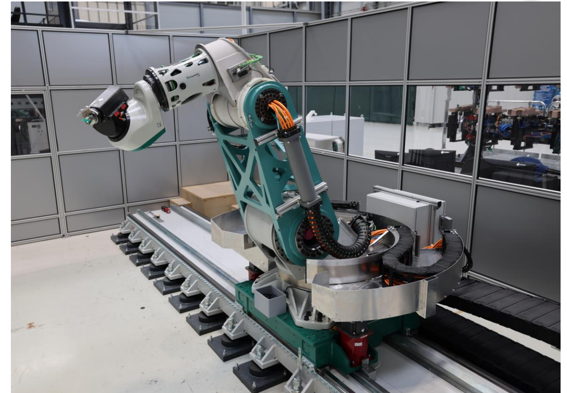
Hochpräziser & hochsteifer Industrieroboter (Nds-Projekt RoMaNi2)
