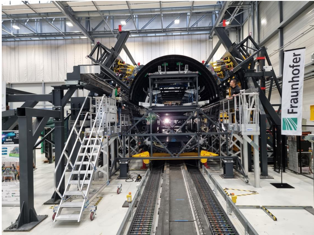
Automatisierte Rumpfmontage (Projekt CleanSky »MFFD«)
