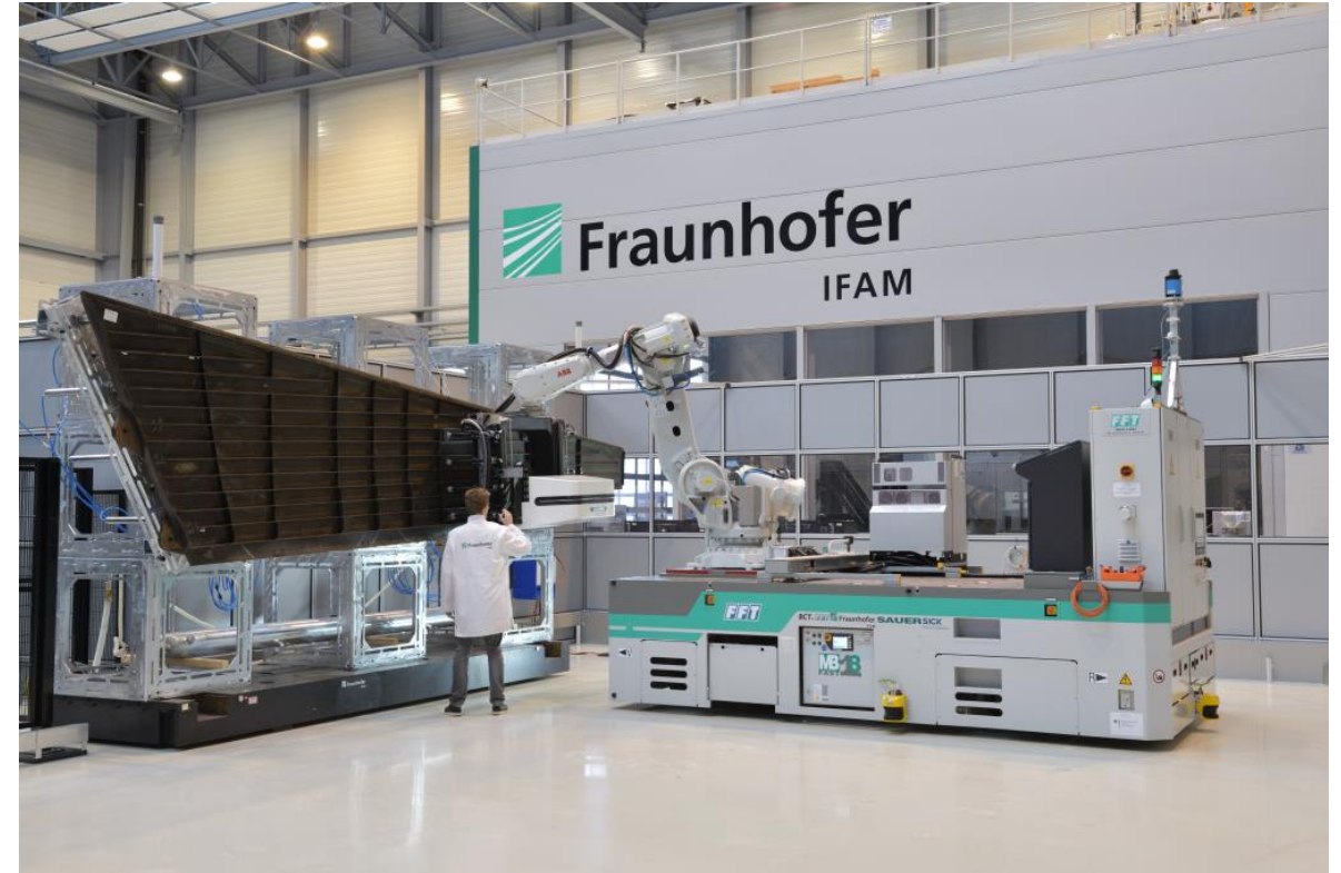
Selbstnavigierender Industrieroboter (LuFo-Projekt MFast 18)
