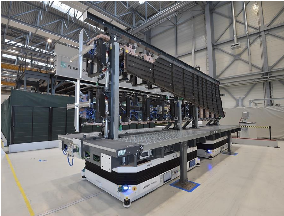
Selbstnavigierendes Spannungsfeld (LuFo-Projekt UniFix)
