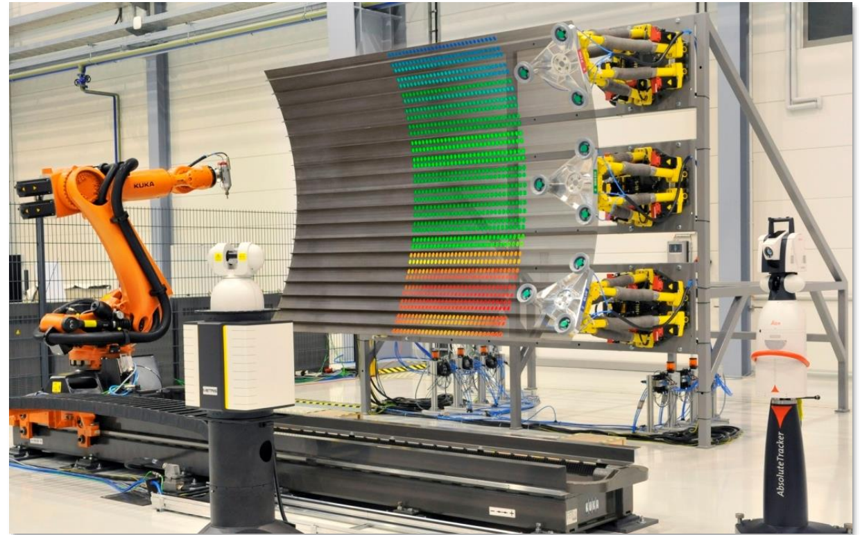
Prinzip der automatisierten Form- und Lagekorrektur (Nds-Projekt)
